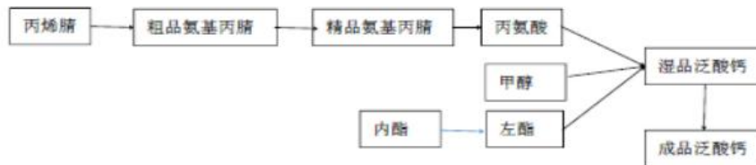
2、泛酸钙项目工艺流程图
