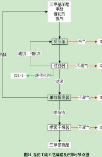
图21 三甲基苯胺工艺流程图及产排污节点图
