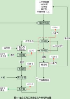
图22 氯化工艺流程图及产排污节点图
