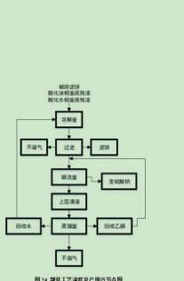
图24 精制工艺流程图及产排污节点图
