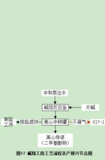
图17 碱化工艺流程图及产排污节点图
