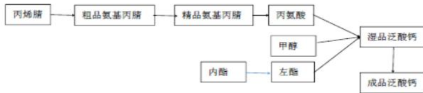
2、泛酸钙项目工艺流程图
