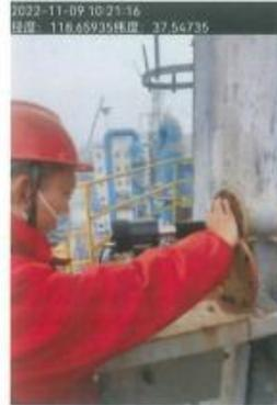
图 3 锅炉烟囱 (DA001) 汞及其化合物检测照片
