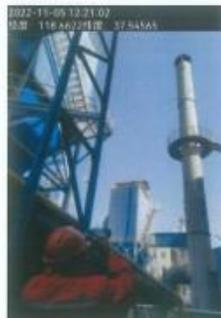
图 6 燃气锅炉排气筒 (DA017) 烟气黑度检
