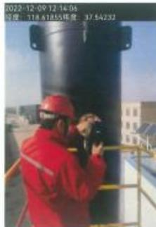
图 1 气炉烟囱(DA014)废气检测照片
